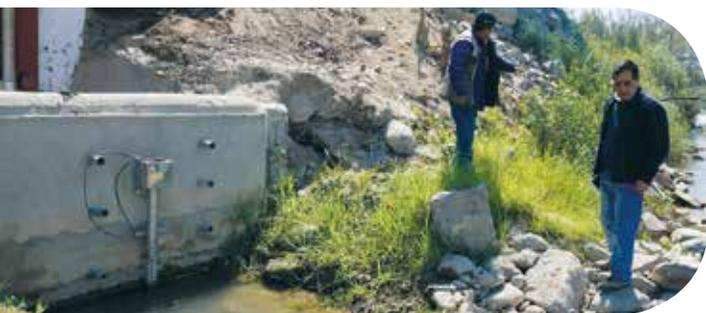
El 09 de agosto 2016 con la presencia de un profesional de la Dirección Gestión de Calidad de los Recursos Hídricos - ANA, se instaló y puso en funcionamiento el sensor de calidad de agua en estación hidrometeorológica de Santo Domingo. El instrumento permite registrar y transmitir en forma automática cinco parámetros físicos del agua tales como: pH, conductividad, oxígeno disuelto, temperatura y turbidez.
