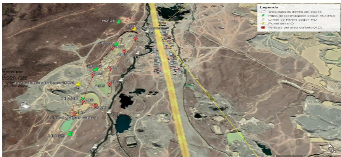
Figura N° 01: Constatación de la extracción de material y el daño ocasionado dentro de la faja marginal del Rio Suches, (polígono de color rojo área dañada dentro de los hitos de color verde, amarillo coordenadas identificados concordantes con el acta de I.O. ); blanco el limite de Rivera
