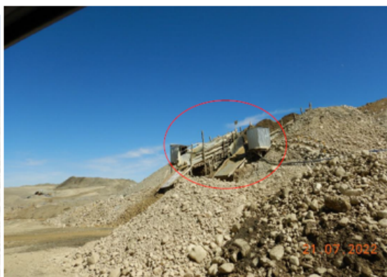
Fotografía N° 2.- Chutes realizando el lavado del material extraído de la faja marginal del río Suches, pertenece a concesión minera santa Inés 2002
