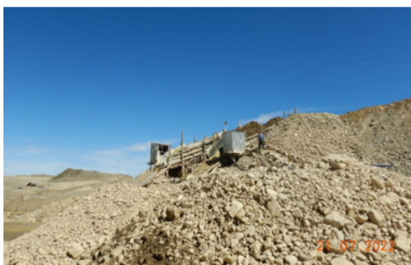
Fotografía N°1.- Chutes realizando el lavado del material extraído de la faja marginal del río Suches, pertenece a concesión minera santa Inés 2002
