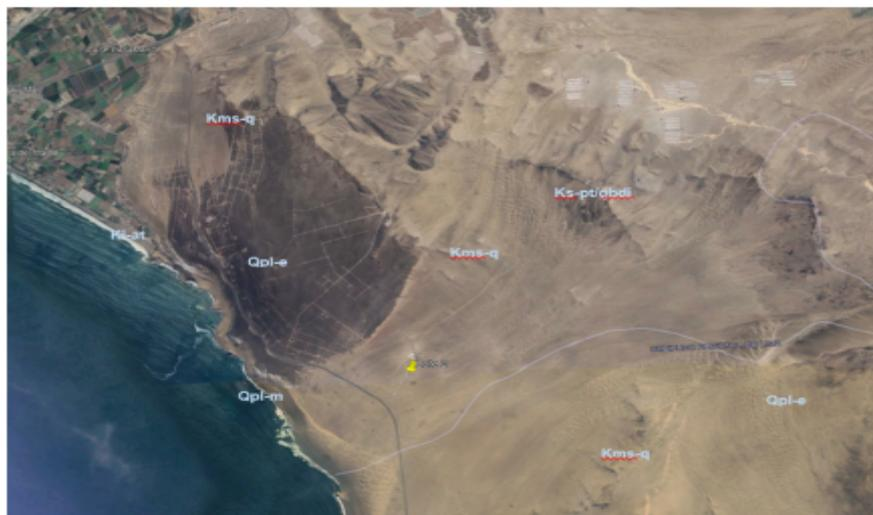
Que, en la imagen siguiente se muestra el sentido del flujo del agua subterránea, el cual de acuerdo con la topografía y geológica de la zona se desplaza en el valle, el pozo proyectado se ubica fuera del acuífero subterráneo que pueda transportar y almacenar agua;
