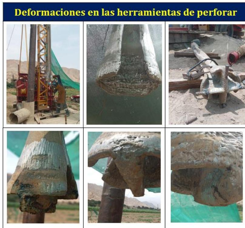
**Imagen 01.** Fotografías anexadas en el expediente; justificando las deformaciones en las herramientas a perforar.
