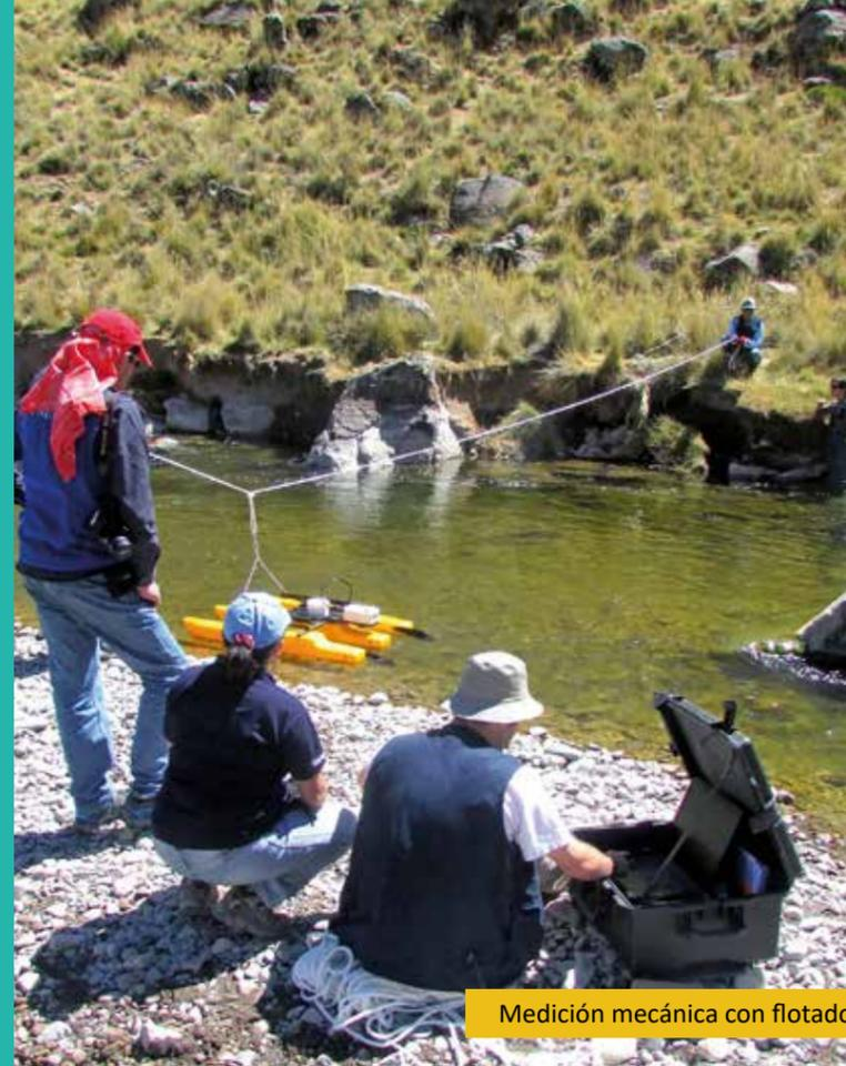
Medición mecánica con flotador
